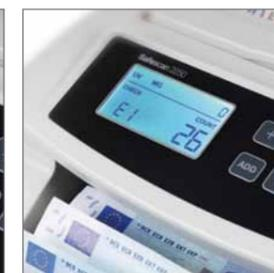
Dreipunkt-Fälschungserkennung mit Audiosignal und automatischem Stopp
